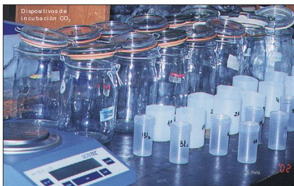
Se efectúa un montaje (por triplicado) utilizando un recipiente de vidrio de boca ancha provisto de cierre hermético. En él, se introduce un recipiente pequeño con una alícuota de 25 g del suelo húmedo (humedad previamente determinada a 105 °C) y un vial
